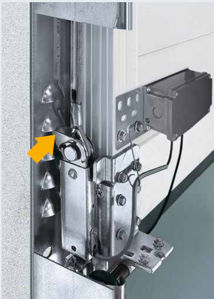
Zatrask ryglujący w kształcie haka blokuje się automatycznie przy próbie podważenia bramy.
